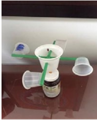
Figura 7. Anemómetro manual para medir la velocidad del viento
