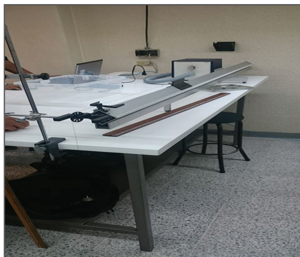
Figura 1. Esquema del montaje del carril de aire
